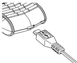
Аккуратно вставьте разъем micro-USB кабеля для передачи данных в разъем телефона. Символ подключения на разъеме должен быть сверху.
