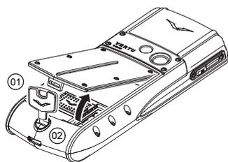
Повернув телефон Vertu обратной стороной к себе, аккуратно вставьте ключ для задней крышки (01) в прорезь фиксирующего винта (02).
