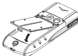
При установке задней крышки сначала вставьте ее внутреннюю защелку (06).
