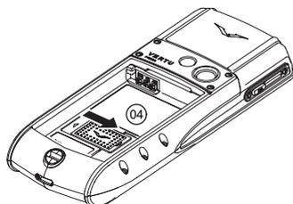
Сдвиньте фиксатор (04) на SIM-карту, чтобы зафиксировать ее на месте.
