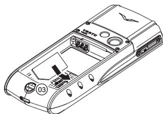
Вставьте SIM-карту желтой контактной пластиной вниз так, чтобы скошенный угол (03) находился справа снизу.
