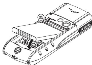
Вставьте аккумулятор так, чтобы его контакты совпали с контактами батарейного отсека (05).
