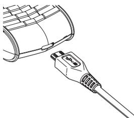
Вставьте разъем зарядного устройства в гнездо в нижней части телефона, как показано на рисунке. Символ подключения на разъеме должен быть сверху.
